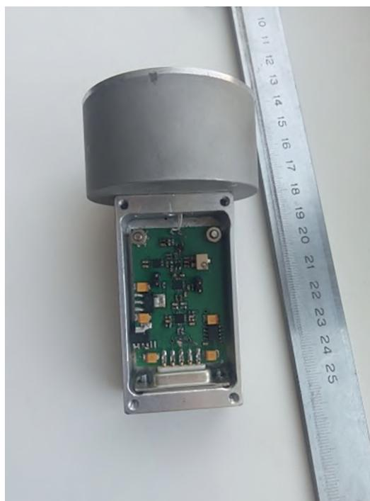
**Рис. 2.** Детекторный модуль, подготовленный для установки на ГДЛ.
