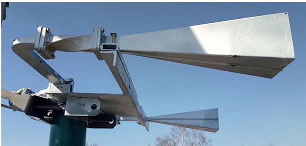
Рис. 3. Внешний вид передающих рупорных антенн.
