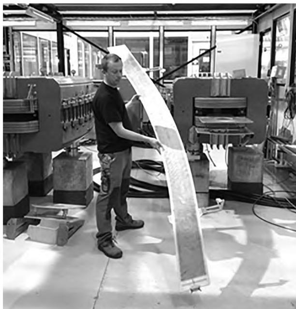
Рис. 2. Демонстрация длинных “интегральных” датчиков. Фотография из работы [2].
