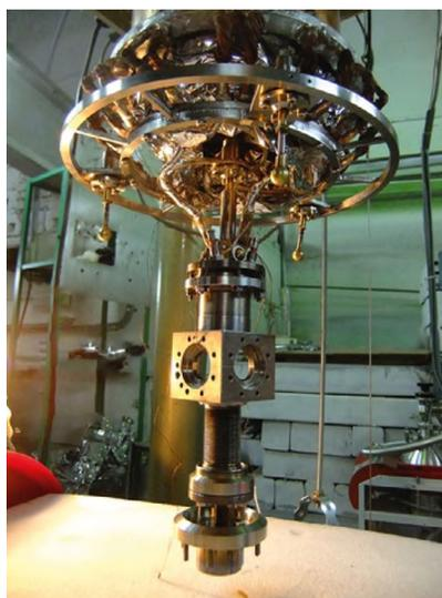
Прототип криогенной корпускулярной водородной мишени
