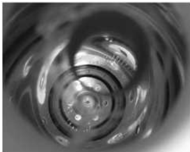
Рис. 2. Вид на внутренние элементы счетчика с торца. Нити на малом диаметре — первый катод, на большом диаметре — второй катод.
