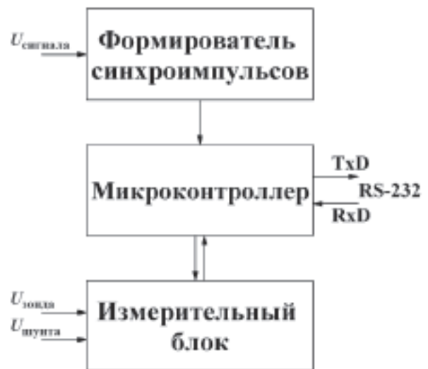
Рис. 2. Структурная схема зондовой системы измерения параметров эмиссионной плазмы.
