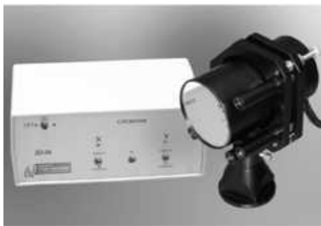
Рис. 6. Внешний вид двухкоординатного оптического дефлектора ДП-04.
