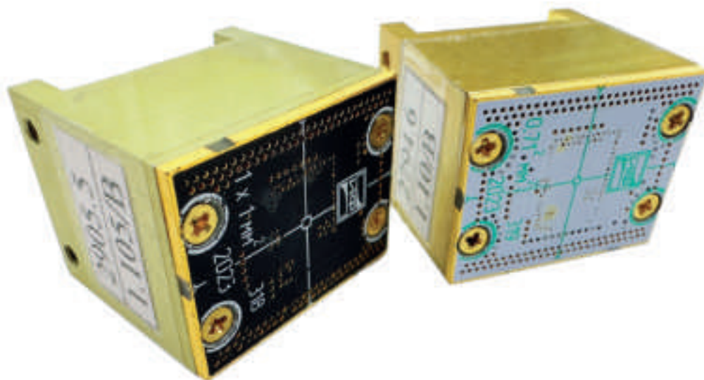
Рис. 5. Фотографии СВЧ-головок с площадью квадратных измерительных отверстий 1.0 \text{ мм}^2 — слева и 0.5 \text{ мм}^2 — справа.
