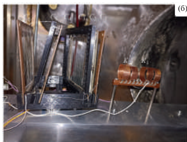
Рис. 2. Фотографии прототипа датчика вектора скорости микрочастиц, установленного в вакуумной камере ускорителя: а – вид сзади, б – вид сбоку.
