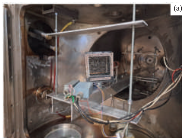
Рис. 2. Фотографии прототипа датчика вектора скорости микрочастиц, установленного в вакуумной камере ускорителя: а – вид сзади, б – вид сбоку.
