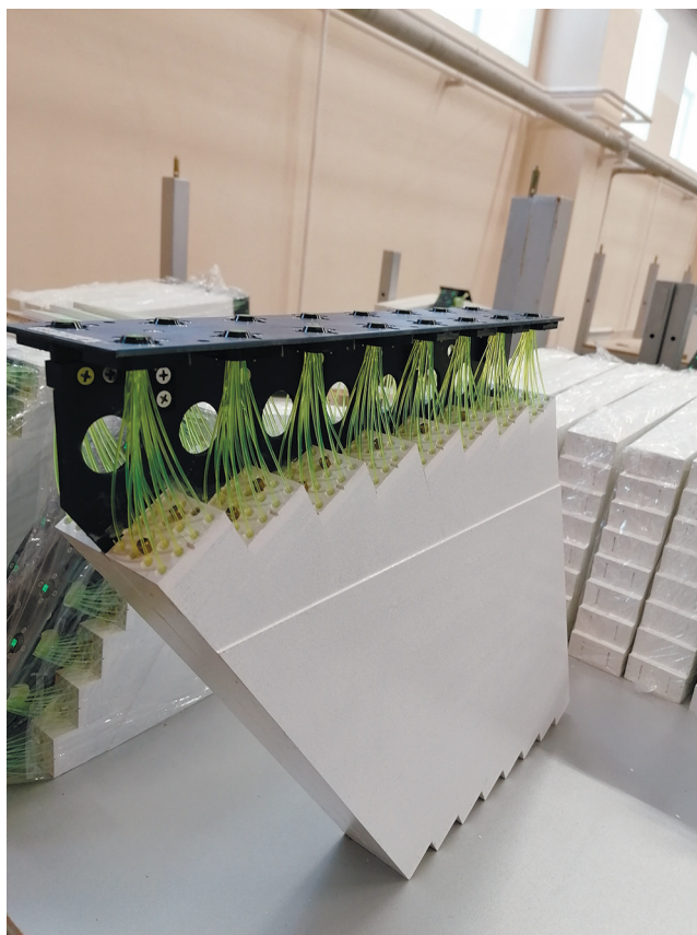
Рис. 4. Фотография одного из типов модулей. Видны жгуты WLS-волокон, вдоль которых предлагается размещение волокна SOF-2.
