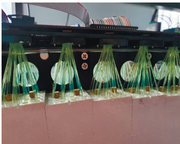
Рис. 6. Фотография фрагмента модуля калориметра с протянутым волокном внутри поликарбонатной трубки. Второе волокно расположено зеркально с другой стороны модуля.
